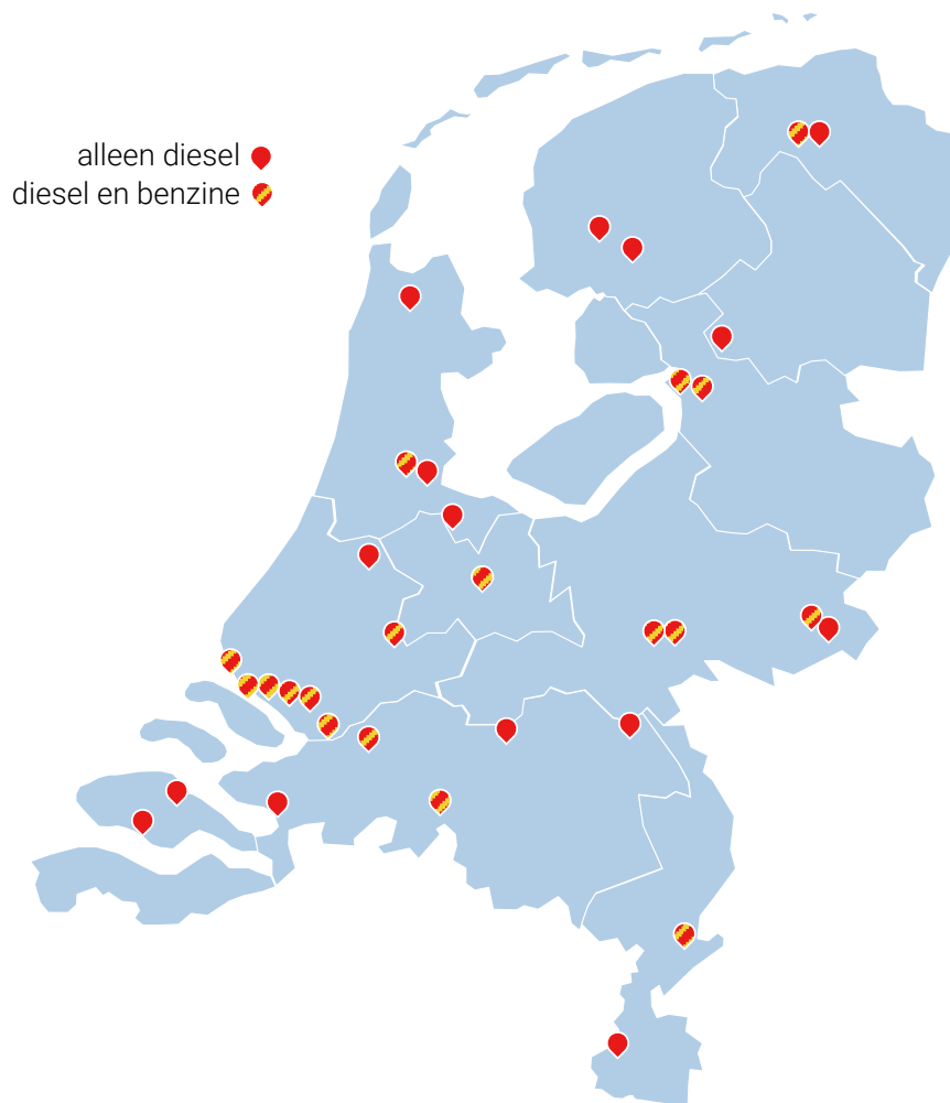
Figuur 2. Overzicht van 33 AGP-brandstofdepots in Nederland, voor levering aan het wegtransport, op basis van openbaar toegankelijke informatie van brandstofleveranciers. De opslagcapaciteit varieert tussen depots, van 2 tot 66 miljoen liter.
